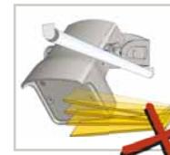
Evitez d'installer le détecteur à proximité de lampes néon ou d'objets en mouvement.
