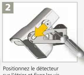
Positionnez le détecteur sur l'étrier et fixez les vis fermement.
