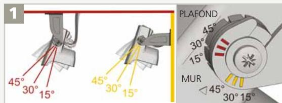
Ajustez l'angle du détecteur pour positionner le champ de détection.
