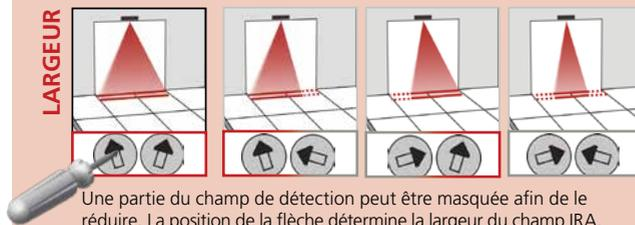
Une partie du champ de détection peut être masquée afin de le réduire. La position de la flèche détermine la largeur du champ IRA.
