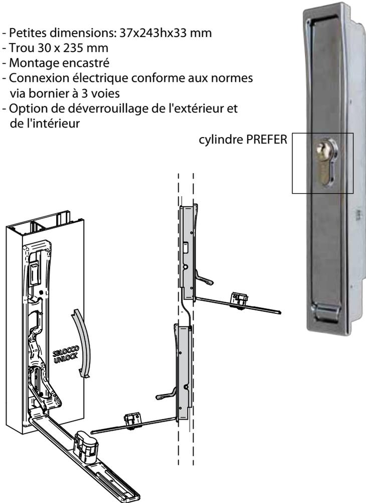
**SLIM37** - Boîte de serrure en aluminium encastrable avec clavier et levier de déverrouillage
