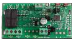
COPY-ONE ricevitore multifrequenza a 2 canali dimensione 46x91mm
