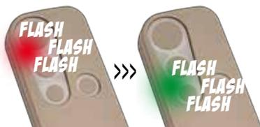
**Se si sta tentando di memorizzare un radiocomando non compatibile, dopo circa 10 sec. dall'inizio della trasmissione del radiocomando da duplicare, entrambi i led iniziano a lampeggiare alternativamente.**
