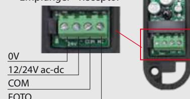
**step 4** Effettuare i collegamenti come indicato nello schema (ricevitore/trasmettitore). Fissare le fotocellule in posizione frontale, allineati sullo stesso asse e alla stessa altezza (min. 25 cm da terra). Se il posizionamento, l'allineamento ed il collegamento sono eseguiti correttamente, il LED rosso sul ricevitore sarà spento. Ogni qualvolta che si interrompe il raggio, il LED rosso si accende.
