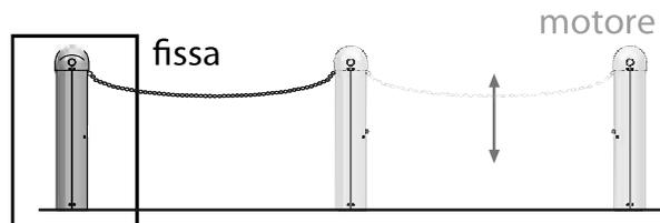
Colonna Fissa POLY (senza motore). Elemento d'arredo urbano utile come limitazione di aree. Abbinabile anche ad una automazione Poly come esempio in figura.
