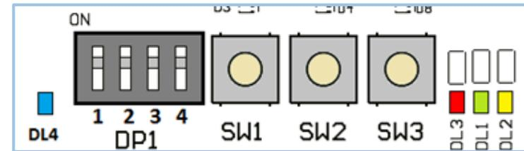
***Esequire il settaggio dei dip-switches a centralina NON alimentata***
