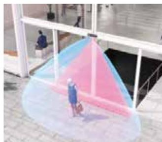
**IXIO-DT** abbina un sensore di movimento radar per l'apertura della porta a una tenda doppia a infrarossi attivi per la protezione degli utenti. Il **movimento** (apertura e chiusura porta) viene gestito da un radar-doppler a microonde mentre la **sicurezza** degli utenti è garantita grazie a 2 tende da 24 spot di infrarossi attivi con analisi dello sfondo.
