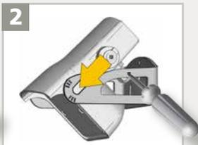
Posizionate il rilevatore nella staffa e fissate le viti saldamente.
