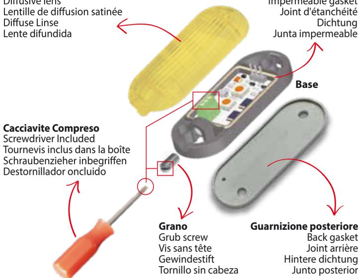
Utilizzare la dima per segnare i punti di fissaggio alla parete. In base al tipo di alimentazione disponibile, alimentare la scheda considerando, in caso di alimentazione 12/24Vdc, il morsetto "COM" come morsetto dove collegare il "meno". Attraverso il **JUMPER** presente sulla scheda è possibile selezionare lampeggio (jumper su centrale + dx) o luce fissa (jumper su centrale e sx).
