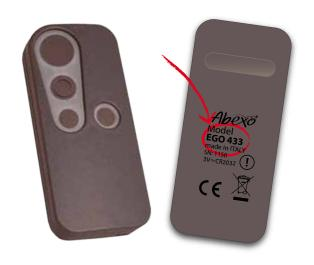
Émetteur 4 canaux avec fréquence 433,92 MHz et autoapprentissage. Entièrement réalisé en Italie, **EGO433** peut apprendre les codes fixes et les HCS sans clé: chaque bouton peut être programmé individuellement afin de stocker 4 émetteurs différents dans un seul dispositif. Il peut générer des codes uniques qui peuvent être mémorisés dans les récepteurs.
