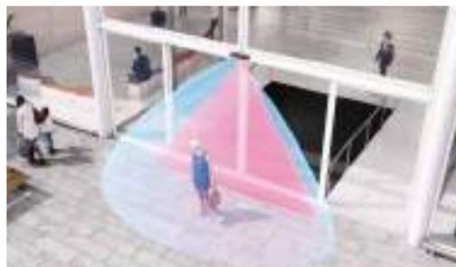
**VIO-DT** abbina un sensore di movimento radar per l'apertura della porta a una tenda doppia a infrarossi attivi per la protezione degli utenti. Il **movimento** (apertura e chiusura porta) viene gestito da un radar-doppler a microonde mentre la **sicurezza** degli utenti è garantita grazie a 2 tende da 24 spot di infrarossi attivi con analisi dello sfondo.
