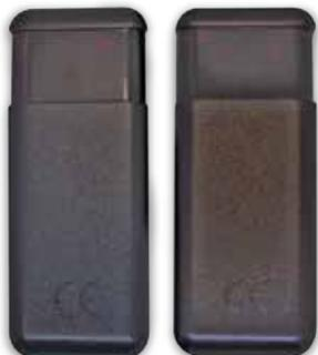
E' possibile orientare i raggi infrarossi (rotazione 180°) per permettere l'allineamento del trasmettitore e del ricevitore anche in situazioni in cui i punti di fissaggio non sono perfettamente allineati.
