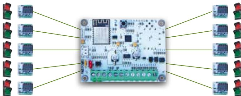
Possibilità di gestire fino a 10 semafori connessi
