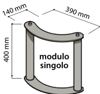
E' un modulo universale di protezione dei sistemi di apertura e non solo. E' composto da una struttura metallica modulare che può adattarsi a diversi utilizzi, come per esempio a protezione dell'alzacatena "POLY" (2 elementi) o di barriere, motoriduttori per cancelli scorrevoli.
