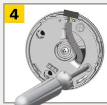
Installate il supporto di montaggio e fissate correttamente le 4 viti per evitare delle possibili vibrazioni.
