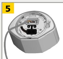
Aprire il coperchio della protezione, collegate il connettore ed inserite il cavo nel passaggio.
