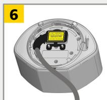
Chiudete il coperchio di protezione e fissatelo saldamente.
