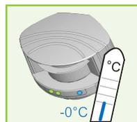
Lasciate alimentato il laser in caso di utilizzo in ambienti con temperature inferiori a -10°.
