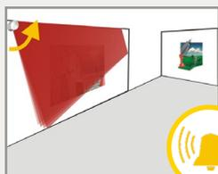
Il rilevatore memorizza una foto del pavimento e segnala un errore in caso di cambiamento di posizione.
