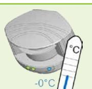
Lasciate alimentato il laser in caso di utilizzo in ambienti con temperature inferiori a -10°.
