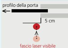
Regolate l'angolo d'inclinazione del rilevatore con una brugola. Il fascio laser visibile deve trovarsi a 5 cm dal profilo.
