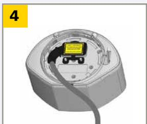
Aprirete il coperchio della protezione, collegate il connettore ed inserite il cavo nel passaggio. Chiudete il coperchio di protezione e fissatelo saldamente.
