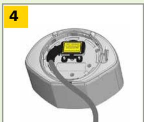
Aprite il coperchio della protezione, collegate il connettore ed inserite il cavo nel passaggio. Chiudete il coperchio di protezione e fissatelo saldamente.
