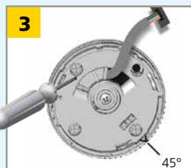
Installate il supporto di montaggio e fissate correttamente le 4 viti per evitare delle possibili vibrazioni.
