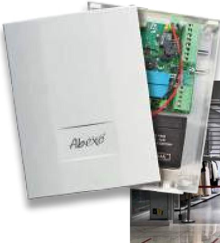
**SH230POWER** ist eine elektronische Steuerung mit integriertem Empfänger, das mit allen 433 Mhz Festcodes und einigen 433 Mhz\* Rolling Codes kompatibel ist. Es hat die Fähigkeit, die Elektrobremse von motorisierte Rollläden auch bei Ausfall der 230V-Versorgung dank einer Pufferbatterie zu steuern. Die Funktion wird durch drücken von 2 Tasten gleichzeitig für mehr als 3 Sekunden aktiviert.
