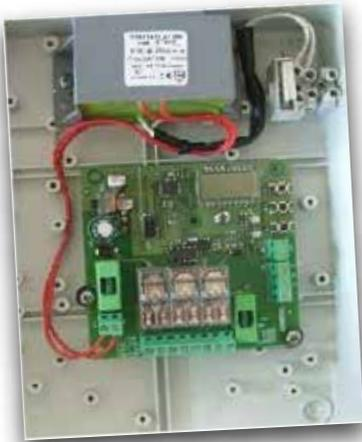
Das **TRAFFIC CONTROL** Steuergerät ermöglicht die 2-Wege-Ampelanlagen Steuerung, also mit maximal zwei Ampeln mit 2 oder 3 Leuchte (230V oder 24V).
