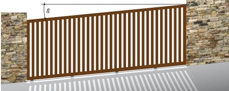
Die CONTROLGIR-Linie ist unentbehrlich bei der Installation von Schiebetoren in Hanglage (es ist eine Zahnstange erforderlich). Wenn der Getriebemotor der Automatisierung losgelassen wird, hat der interne Hydraulikkreis (einstellbar) die Funktion eines "Fallschirm", d.h. er regelt die Abwärtsgeschwindigkeit für den gesamten Torlauf. Die Betriebsgeschwindigkeit muss knapp über der des Getriebemotors eingestellt werden, um die Automatisierung nicht zu beeinträchtigen.
