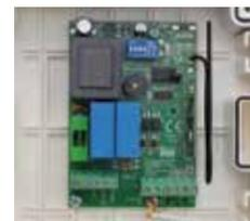
SH230 - Steuerungseinheit für Rollläden
