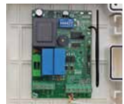
SH230 – unidad de control para persianas con caja exterior
