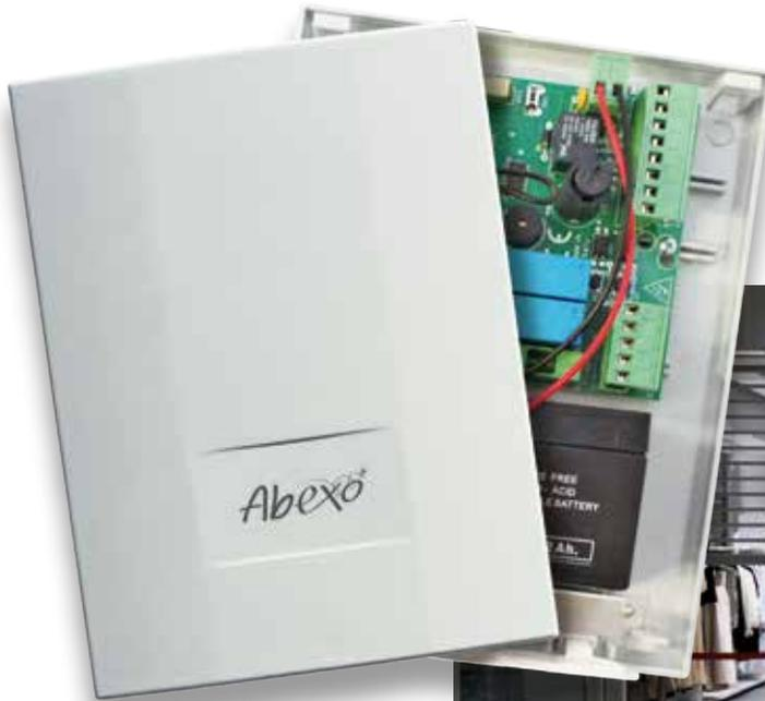
**SH230POWER** ist eine elektronische Steuerung mit integriertem Empfänger, das mit allen 433 Mhz Festcodes und einigen 433 Mhz\* Rolling Codes kompatibel ist. Es hat die Fähigkeit, die Elektrobremse von motorisierte Rollläden auch bei Ausfall der 230V-Versorgung dank einer Pufferbatterie zu steuern. Die Funktion wird durch drücken von 2 Tasten gleichzeitig für mehr als 3 Sekunden aktiviert.
