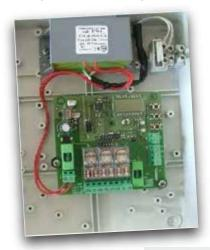
Das **TRAFFIC CONTROL** Steuergerät ermöglicht die 2-Wege-Ampelanlagen Steuerung, also mit maximal zwei Ampeln mit 2 oder 3 Leuchte (230V oder 24V).
