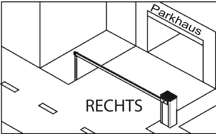
Nachdem die Ausrichtung der Schranke gewählt wurde, muss die Installation des Systems vorbereitet werden, indem das Fundament und gegebenenfalls die Gabelstütze für die Stange im Boden gemauert werden. Bitte beachten Sie die folgenden Abbildungen für die Mauerwerke.
