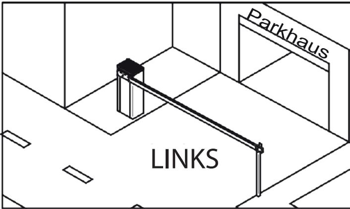
Als "RECHTS" wird eine Schranke bezeichnet, die, wenn man die Automatisierung von außen betrachtet, rechts neben der Einfahrt installiert wird.
