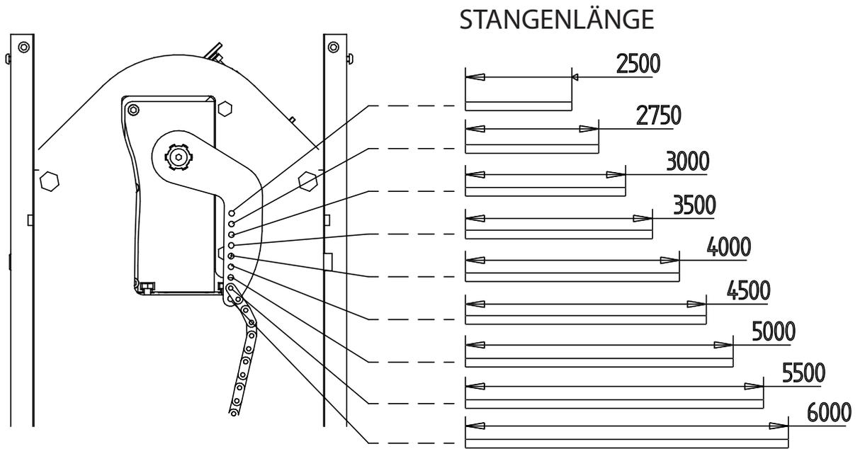
Stellen Sie sicher, dass die Kette gemäß der Länge des Pfostens, der am Schranken installiert werden muss, richtig an den Hebel angeschlossen ist.
