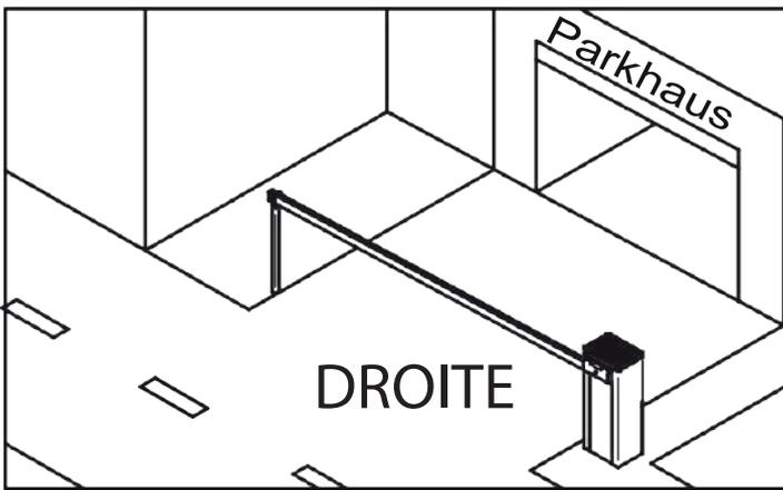
Une fois l'orientation de la barrière choisie, il est nécessaire de préparer l'installation du système en mettant à la terre la base de la fondation et tout support de fourche pour la tige. Faire référence à la figure ci-dessous pour la maçonnerie.
