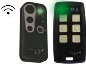
**LED TRS:** la touche de l'EGO PLUS/KUBE a mémorisé le code de la télécommande qui vient d'être copiée et **fonctionne avec le récepteur d'origine.**
