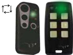
**LED AUTO:** la touche de l'EGO PLUS/KUBE a mémorisé le code de la télécommande qui vient d'être copié et **doit être mémorisé dans le récepteur d'origine** au moyen de la procédure d'auto-apprentissage indiquée au paragraphe 13.
