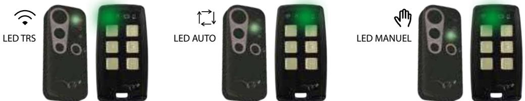
**LED TRS:** la touche de l'EGO PLUS/KUBE a mémorisé le code de la télécommande qui vient d'être copiée et **fonctionne avec le récepteur d'origine.**
