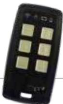
Sur la télécommande **EGO-KUBE**, pour remplacer la pile, il faut dévisser la vis sur le dos et agir avec un petit tournevis à fente dans les 2 zones comme indiqué dans l'image.
