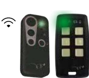
**LED TRS:** la touche de l'EGO PLUS/KUBE a mémorisé le code de la télécommande qui vient d'être copiée et **fonctionne avec le récepteur d'origine**.
