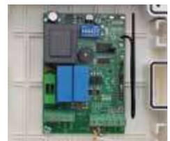
SH230 - Steuerungseinheit für Rollläden
