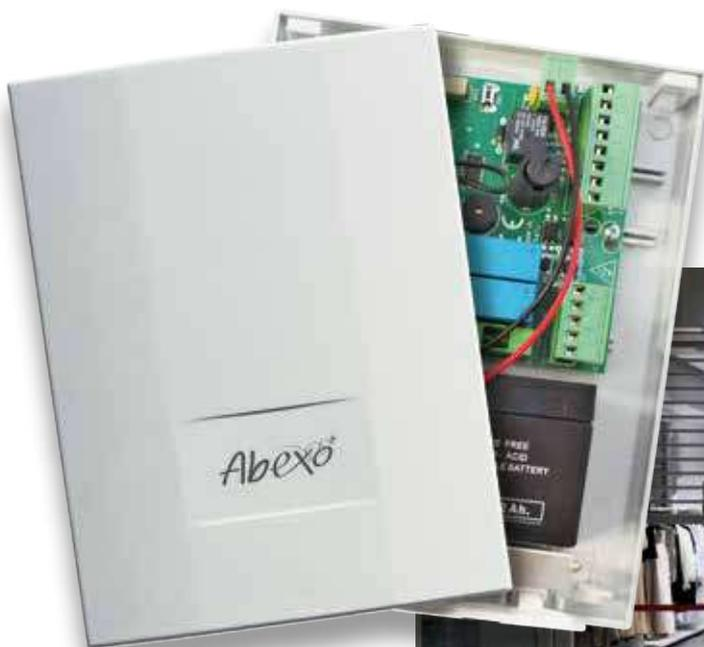
**SH230POWER** es una unidad de control electrónica con receptor integrado compatible con todos los códigos fijos de 433 MHz y algunos códigos rodantes de 433 MHz\*. Su particularidad es la capacidad de controlar y liberar el freno eléctrico de los motores de persiana incluso en caso de corte de corriente de 230 V, gracias a una batería tampón. La función se activa pulsando simultáneamente 2 botones por más de 3 segundos.
