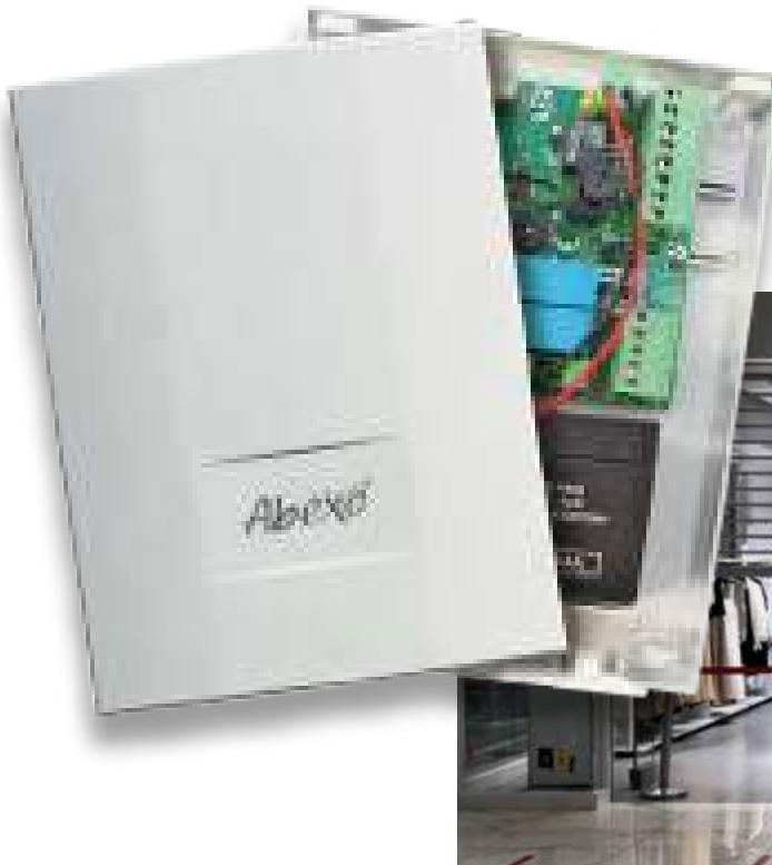
**SH230POWER** es una unidad de control electrónica con receptor integrado compatible con todos los códigos fijos de 433 MHz y algunos códigos rodantes de 433 MHz\*. Su particularidad es la capacidad de controlar y liberar el freno eléctrico de los motores de persiana incluso en caso de corte de corriente de 230 V, gracias a una batería tampón. La función se activa pulsando simultáneamente 2 botones por más de 3 segundos.
