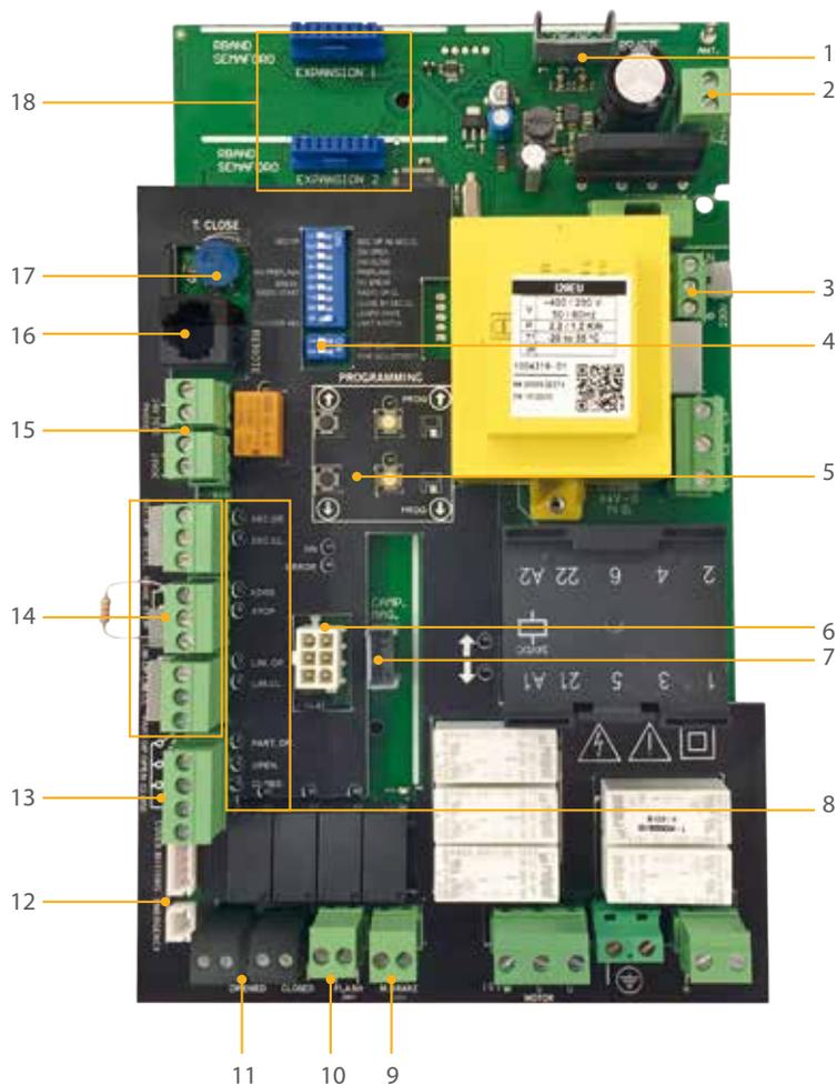
1. Connettore ricevitore ad innesto (STICK/RACK)
