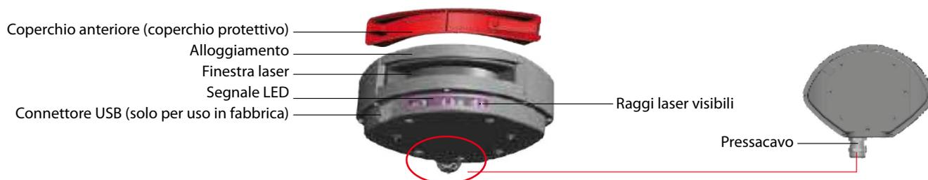
**Tecnologia:** Scanner LASER, misurazione del tempo di volo
