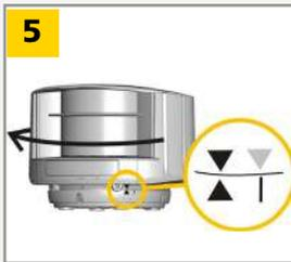
Placez le boîtier sur le support de montage et tournez le détecteur jusqu'à ce que les deux triangles soient face à face.
