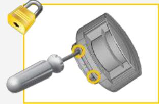
Verrouillez la position du support de montage pour éviter un mauvais fonctionnement causé par des vibrations extrêmes.
