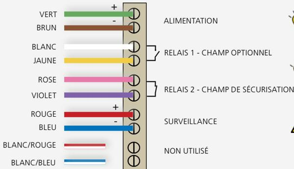
Utilisez le Power Supply Module (24V DC, 0.75 A) si nécessaire.
