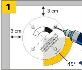
Utilisez le gabarit de montage pour positionner correctement le détecteur. La zone grise représente l'orientation de la zone de détection. Forez 4 trous et 1 trou pour le câble si possible.
