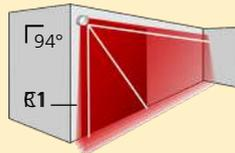
La distance entre les plans intérieurs de 2 détecteurs doit être de max. 20 cm pour une sécurisation conforme à la EN12453.
