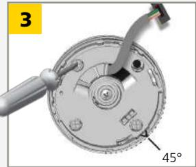
Installez le support de montage et fixez fermement les 4 vis pour éviter toute vibration.
