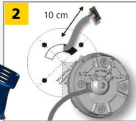
Passez le câble de min. 10 cm à travers l'ouverture. S'il n'y a pas de trou pour passer le câble, utilisez les passages de câble prédécoupés à l'arrière du support.
