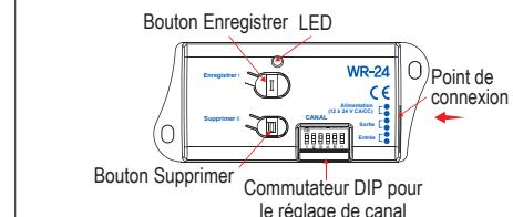
Dispositif de commande automatique de porte
