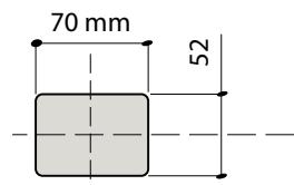
La PFZ è una base di fissaggio senza ingombro esterno. Necessaria se si vuole installare la colonnetta a contatto con la parete.
