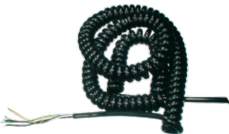
Los **cables espiralados SPK** están fabricados con materiales de alta calidad, lo que los hace adecuados para las instalaciones más exigentes. El factor de extensión es cuatro veces la longitud de bloqueo (BL). Gracias a una mezcla especial de la funda, los cables espiralados son resistentes a los microbios, a la hidrólisis y a casi todos los aceites minerales. Además, son estables frente a los rayos UV y libres de halógenos.
